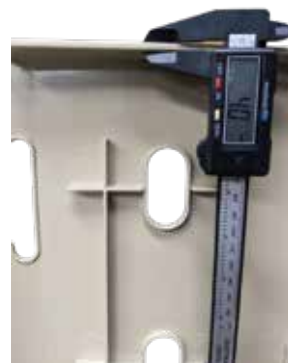
床面板背面 之十字連結串列補強
