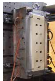
床面板背面之 十字連結串列補強 床面板厚度4mm
